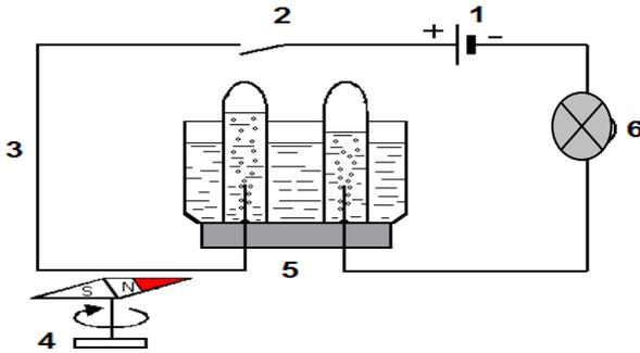
(2) ما هو تأثير التيار الكهربائي عندما يعبر المحلل (العنصر 5)؟
