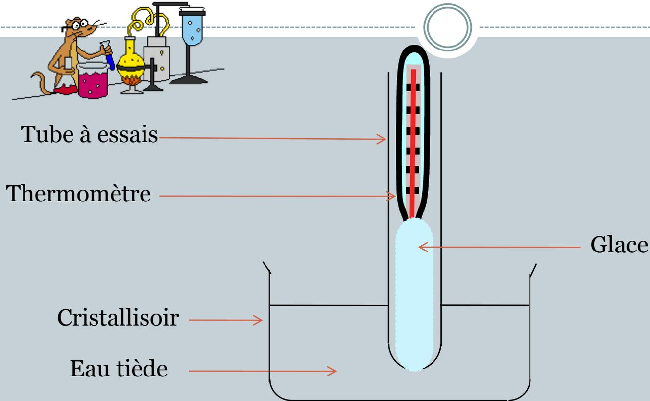
**N.B:** Relève la température  $\theta$  de la glace se trouvant dans le tube toutes les minutes et note l'état physique dans lequel se trouve l'eau pendant son chauffage. Arrête l'expérience 2 à 3 minutes après la transformation de la totalité de la glace en liquide. Récupère le contenu du tube et mesure de nouveau sa masse. Compare la à sa valeur initiale.
