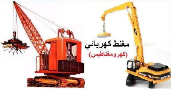
في الحياة اليومية لحمل الأجسام الحديدية الثقيلة كالنفايات الحديدية او حاويات البضائع الكبيرة نستعمل المغناطيس الكهربائي و يسمى الكهرومغناطيس و هو عبارة عن وشيعة ملفوفة حول قطعة حديدية نستطيع التحكم في قوة مغناطيسها بتغيير شدة التيار الكهربائي فحصل على مغناطيس قوي يمكنه جذب سيارة مثلا
